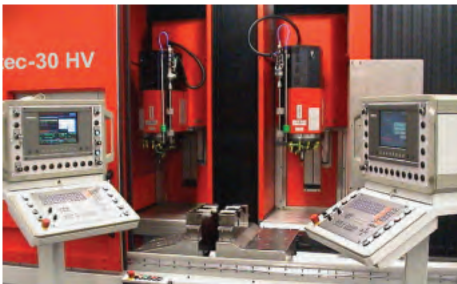
matec-30 HV mit 2 Fahrständen und 9 CNC-Achsen
