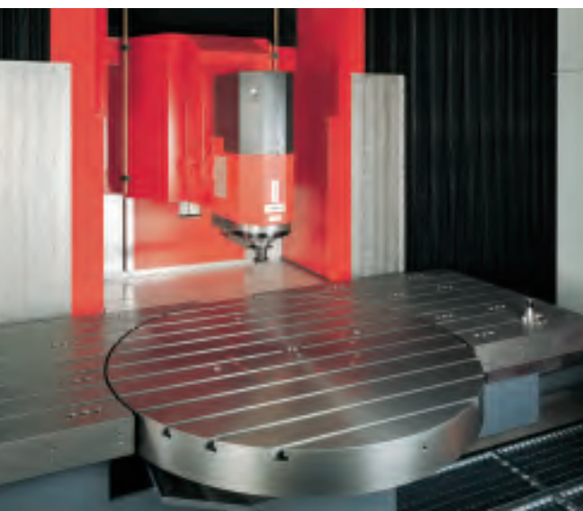
matec-30 HV mit integriertem Rundtisch 1450 mm
