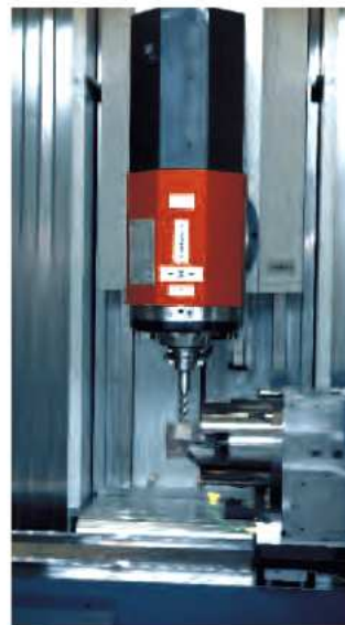
Bearbeitung an der Gegenspindel
