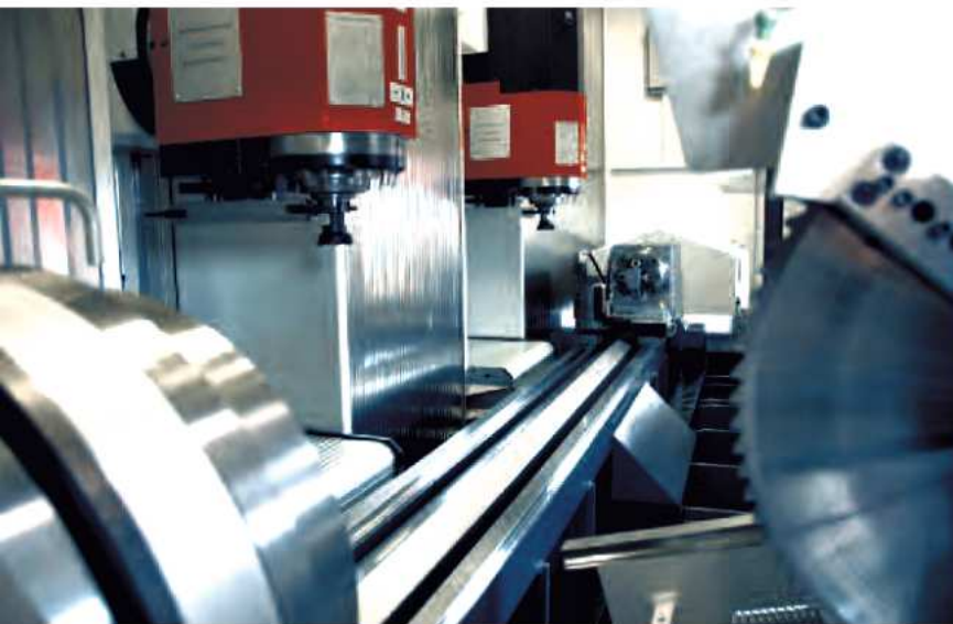
Arbeitsraum mit 2 Fahrständern, Gegenspindel bzw. CNC-Rundtisch und Sägeeinrichtung
