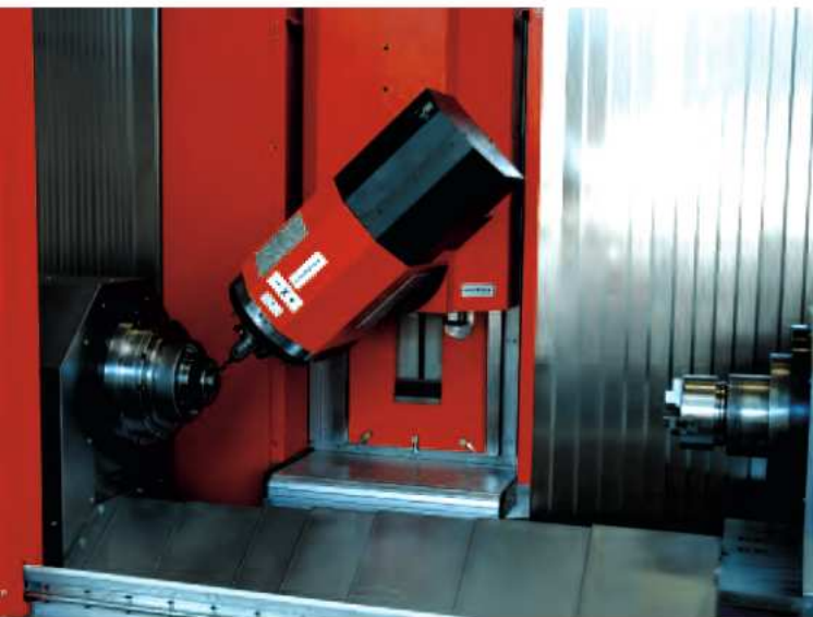
Werkstückbearbeitung an der Hauptspindel
