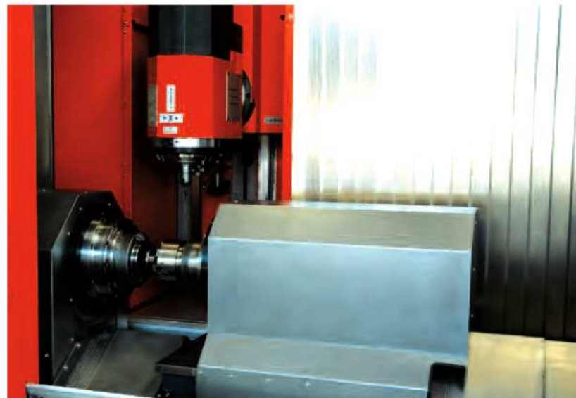
Übergabe des Werkstücks in die Gegenspindel
