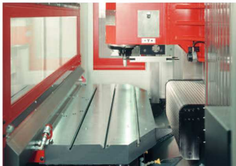
Arbeitsraum mit perfektem Späneabfluss
