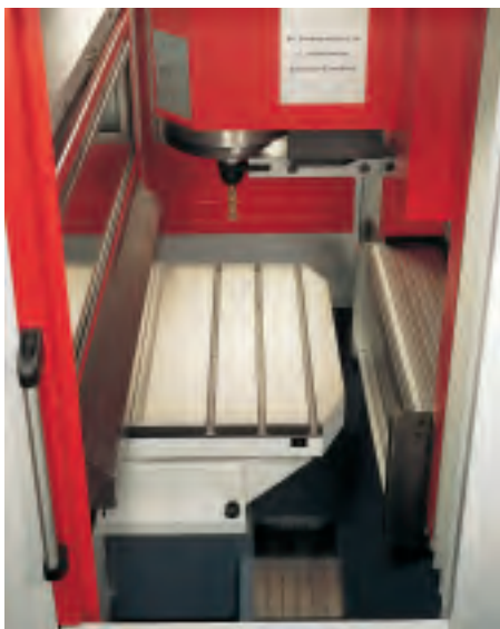
Arbeitsraum mit perfektem Späneabfluss
