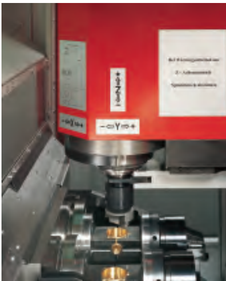
Arbeitsraum mit 2 CNC-Rund- tischen, Spannvorrichtung und Bearbeitungswerkzeug
