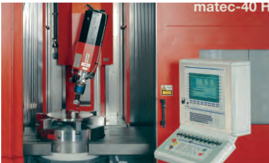
Integrierter Rundtisch mit Torque-Antrieb n_{\max} = 500 \text{ min}^{-1}
