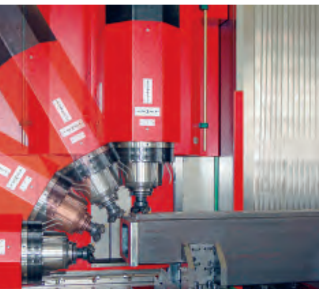
Winkelkopf stufenlos \pm 105^\circ
