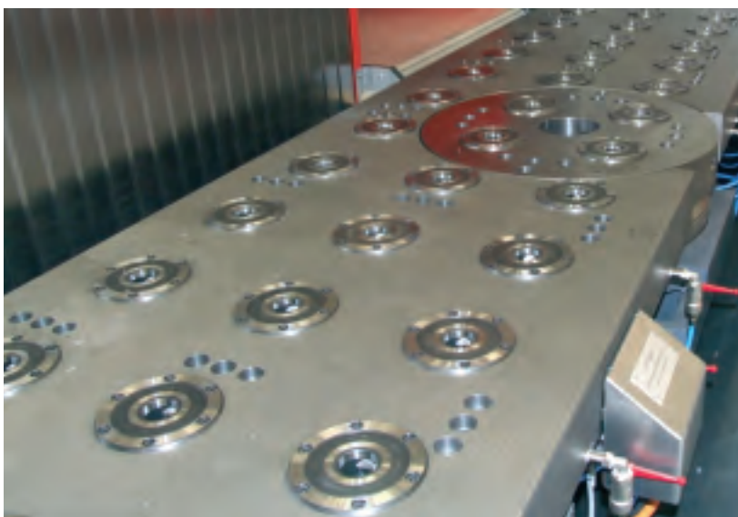
Maschinenbett mit integriertem Rundtisch und eingesetztem Nullpunktspannsystem
