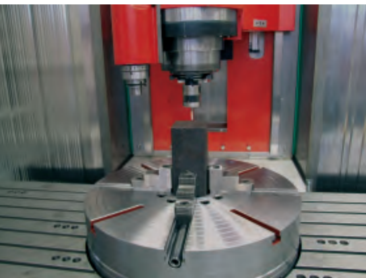
Arbeitsraum mit integriertem Rundtisch und aufgesetztem Backenfutter
